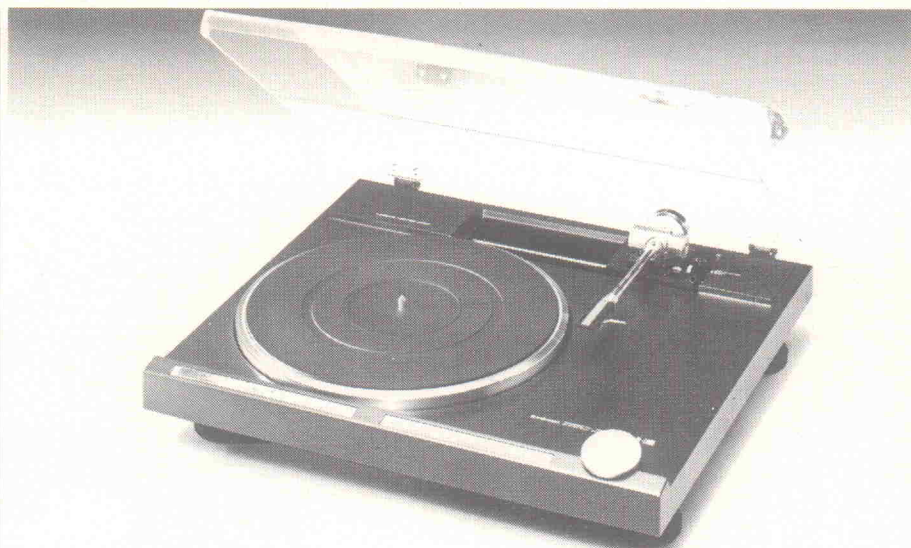
Der Pioneer PL-L1000 mit Tangential-Tonarm, der von einem Linearmotor angetrieben wird. Die Tonarmaussteuerung wird über einen optischen Sensor gesteuert, dadurch wird eine Genauigkeit von 0,2° erreicht.
